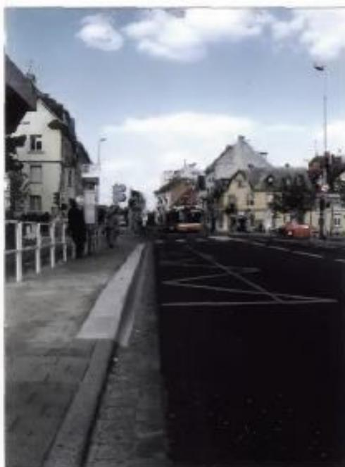
Figure 7 : exemple de guidage visuel par ligne peinte au sol – réseau de Strasbourg
